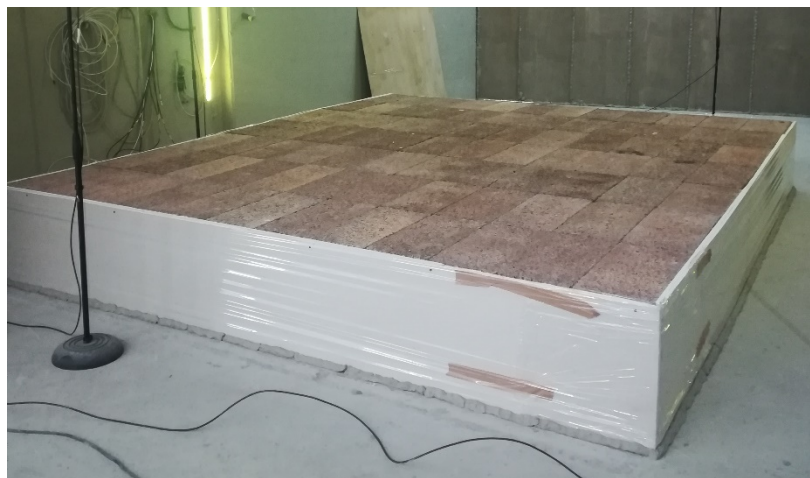
Figura 2: Posizionamento campione in camera riverberante
