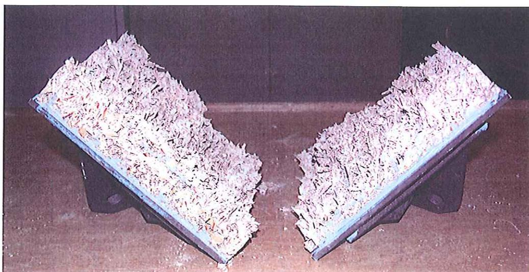
fig. 2 - particolare della rottura coesiva
