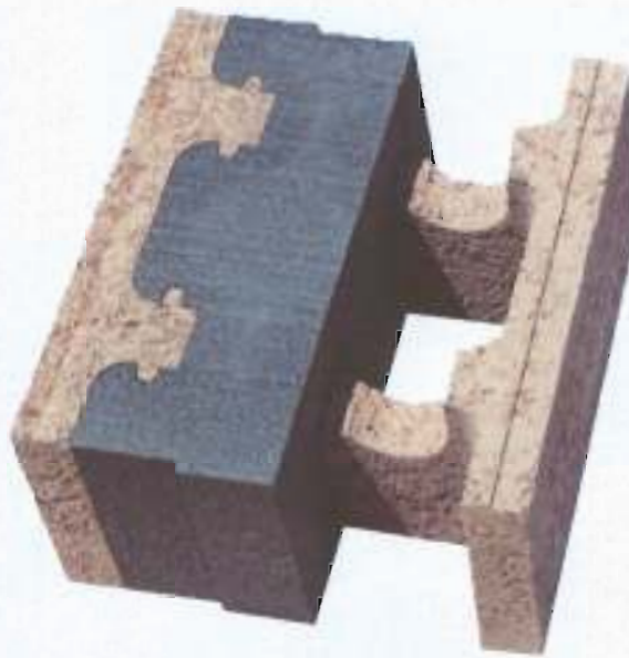
Immagine del blocco cassero utilizzato per la realizzazione del campione.
