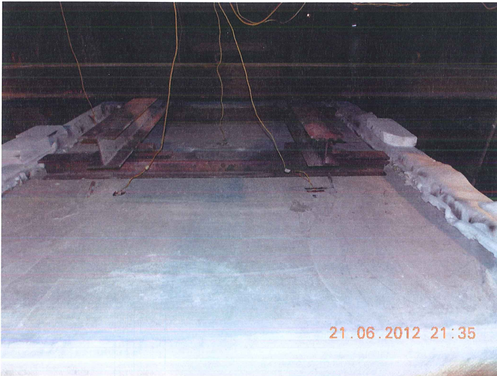
Foto 3. Lato non esposto al fuoco del solaio dopo la prova
