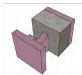
Polovina HD Bloka -siječe se na gradilištu
