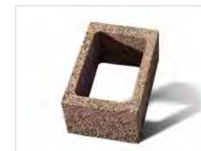
Blok za stub 33X50 cm sa otvorom 25x38 cm 38X50 cm sa otvorom 30x38 cm 44X50 cm sa otvorom 33x39 cm Mogućnost ubacivanja 5 cm ili 8 cm izolacije
