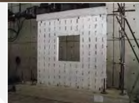
Lijevo: seizmički test na ISOTEX dvospratnom zidu.
